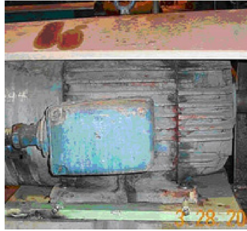
Motore elettrico surriscaldato. Temperatura rilevata dalla Termocamera è di 110°C
